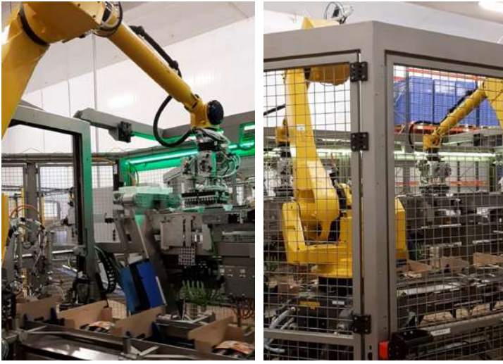
Ligne automatisée : encaissage
